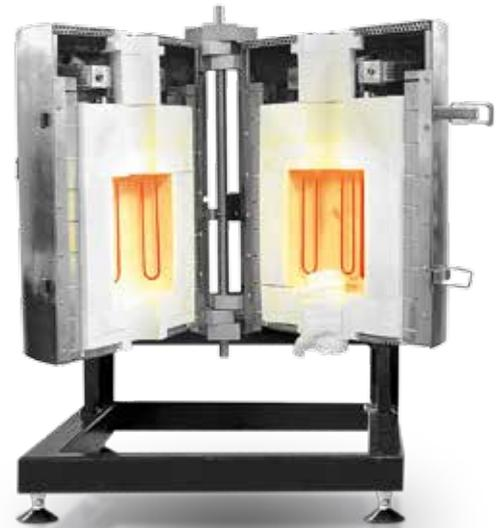
HTRV-A 70-250/17: Вертикальная раскладная трубчатая печь для высокотемпературной обработки с длиной зоны нагрева 250 мм и максимальной рабочей температурой 1700 °C.
