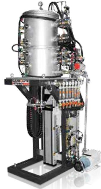
KZA-V 25-500/20: Печь для выращивания кристаллов методом Бриджмена с длиной зоны нагрева 500 мм, максимальной рабочей температурой 2000°C, графитовыми нагревательными элементами (4 зоны нагрева), для работы в среде вакуума и инертного газа, с полностью автоматическим управлением и функцией занесения данных в системный журнал.
