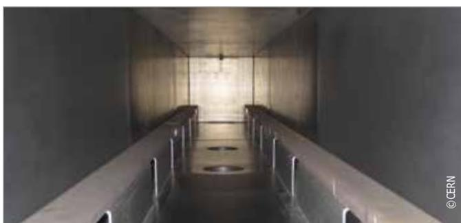
Герметичная реторта длиной 7 м для изготовления сверхпроводящих катушек.
