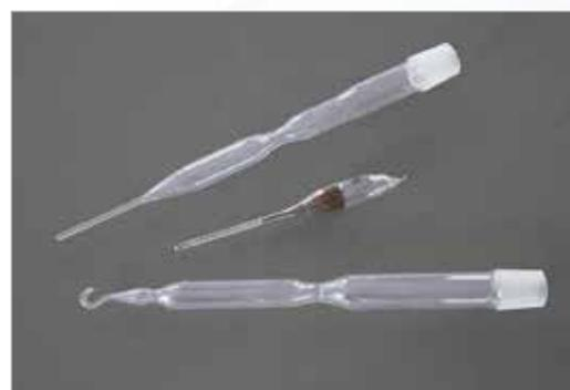
В верхней части рисунка показана ампула для выращивания кристаллов методом Бриджмена с наконечником и оттянутым концом. В средней части рисунка показана запаянная с одного конца ампула. Полученный таким образом наконечник становится местом образования зародыша кристалла, по прохождению ампулой зоны температурного градиента. В нижней части рисунка показана ампула с крючком.
