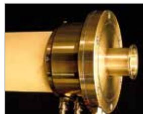
Для печей всех типов можно заказать оборудование для работы с защитным газом и оборудование для работы с вакуумом/защитным газом. Использование трубок из плотного оксида алюминия  $Al_2O_3$  высокой чистоты и оксида алюминия/диоксида кремния ( $Al_2O_3 / SiO_2$ ) в сочетании с фланцами из нержавеющей стали с водяным охлаждением позволяет установить газонепроницаемую испытательную камеру, в которой можно создавать определенные рабочие среды.
