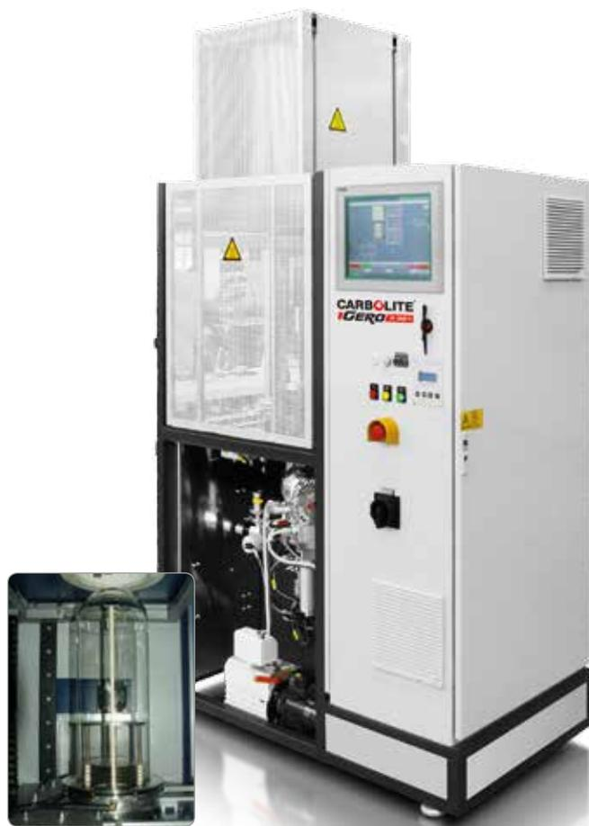
Трубчатая печь в верхнем положении. Кварцевая трубка в нижней части печи остается подсоединенной к вакуумному насосу.
