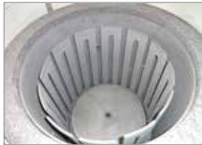
Нагревательная кассета с графитовыми нагревательными элементами
