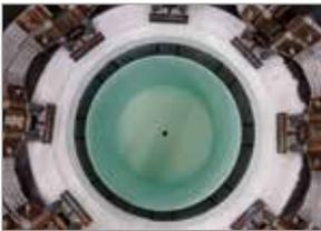
Нагревательная кассета с керамическими нагревательными элементами
