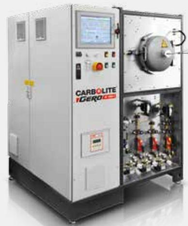
GLO 40/11: Печи с полезным объемом 40 л и максимальной рабочей температурой 1100°C при давлении ниже атмосферного. Данные печи предназначены для термического удаления связующих веществ.
