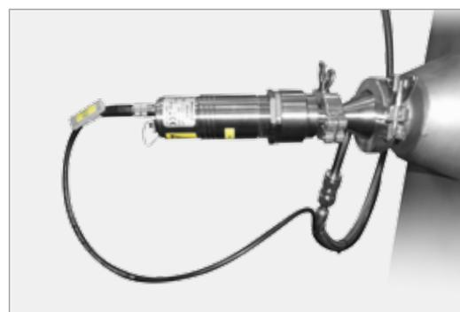
Пирометр, позволяющий измерять температуру в диапазоне до 3000 °C. Пирометр измеряет уровень теплоизлучения в зоне нагрева печи, проходящего через смотровое окошко с кварцевым стеклом. Скользящая термопара используется для регулировки пирометра. По специальному трубопроводу в область смотрового окошка подается газ.
