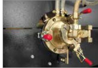
В качестве дополнительного оборудования фланцы могут оснащаться быстрьюемными уплотнениями.
