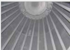
На рисунке показан боковой нагреватель, состоящий из графитовых стержней, симметричное расположение которых обеспечивает высокую однородность температуры.
