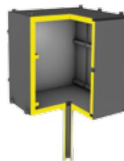
Графитовая реторта с газоотводной трубкой
