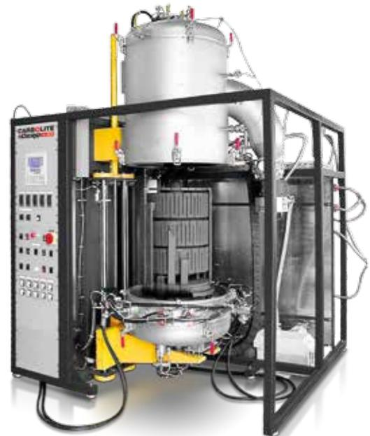
KZA-ST 400-400/16: Печь для выращивания кристаллов методом Стокбаргера с диаметром рабочей камеры 400 мм, длиной зоны нагрева 400 мм и максимальной рабочей температурой 1600°C.
