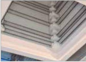
Внутренняя поверхность колпака печи НВ, к которой крепятся нагревательные элементы из фехрала (CrFeAl), позволяющие достигать максимальной рабочей температуры 1300 °C.
