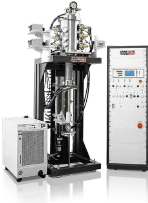
Специальные печи для выращивания кристаллов методом Бриджмена с максимальной рабочей температурой 2200°C: Образец медленно перемещается по рабочей камере из зоны высокой температуры в резервуар с жидким металлом с низким давлением пара (сплав индия и галлия). Подобная конструкция позволяет создавать высококачественные температурные градиенты.
