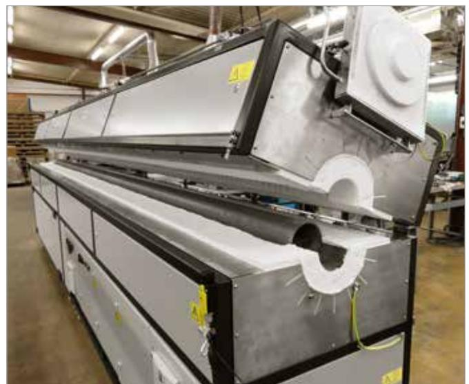
Раскладная трубчатая печь с длиной зоны нагрева 5,5 м и максимальной рабочей температурой 1000°C.
