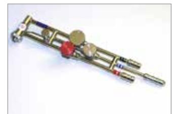
Горелка для плавки, графитизации и нагрева
