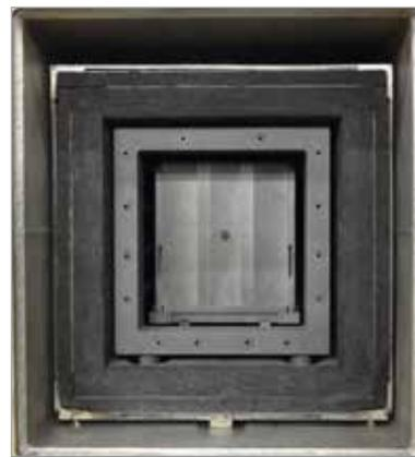
НТК 8 GR/22: Камерные печи с полезным объемом 8 л и максимальной рабочей температурой до 2200°C. Графитовая теплоизоляция печей состоит из нескольких слоев. Внутри нагревательной cassette находится реторта, положение которой строго симметрично.
