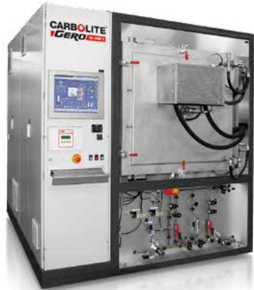
НТК 400 GR/22: Камерные печи для термообработки при высоких температурах с полезным объемом 400 л, рабочей температурой до 2200°C и автоматическим управлением с сенсорного дисплея
