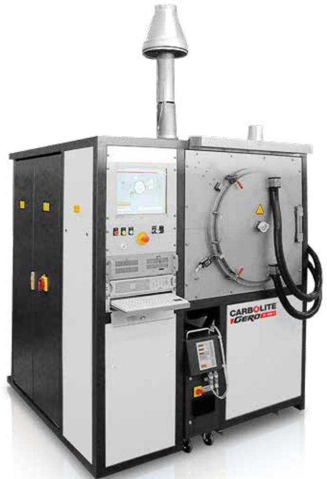
EVO 120/1.5: Печи для удаления связующих веществ с полезным объемом 120 л и максимальной рабочей температурой 150°C. Рекомендуемая рабочая температура печи составляет 120°C. Азотная кислота, испаряясь, смешивается с азотом и подается в печь для каталитического удаления связующих.
